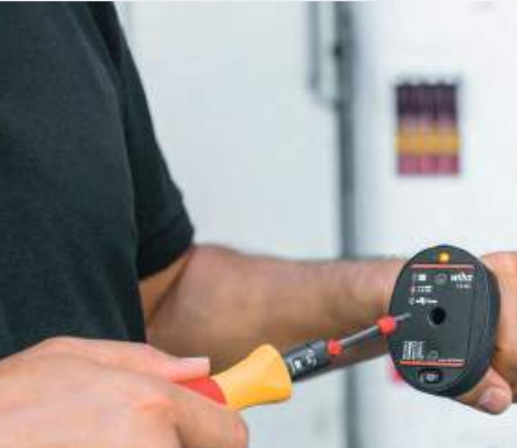
Comprobación de herramientas dinamométricas en cualquier lugar
